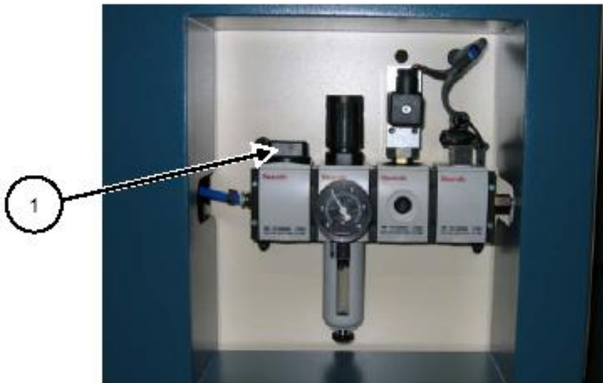
2.8. ábra (Levegő előkészítés)
